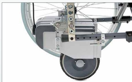
Placez-le simplement dans les fixations préalablement montées sur le fauteuil.
